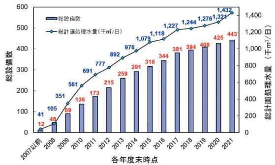
図3 紫外線照射装置の総設備数と総計画処理水量の推移（令和3年度末時点）
